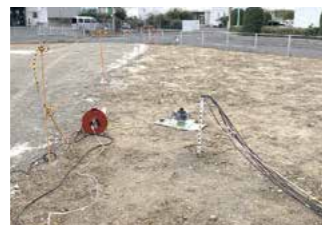
埋設水素パイプラインの漏洩センサ評価に関する実証研究 ■事業主体 九州計測器(株)
